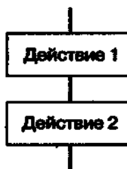
Рис. 2.8. Алгоритмическая конструкция «следование»
