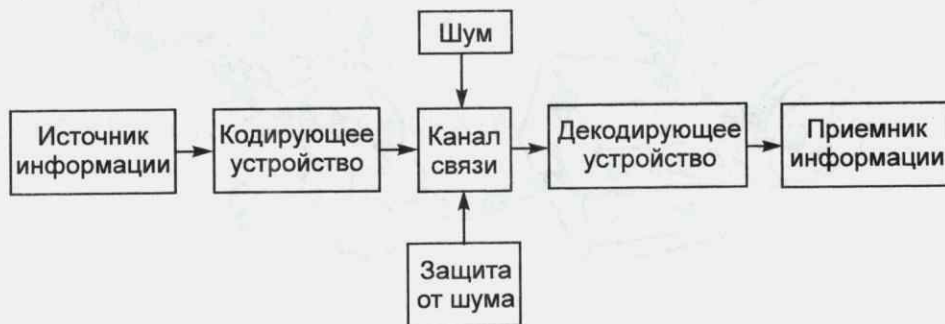
Рис. 1.3. Схема технической системы передачи информации
